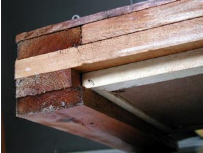
Figure 2: le tiroir d'échantillonnage s'insère dans des rainures aménagées à même la base du plateau
